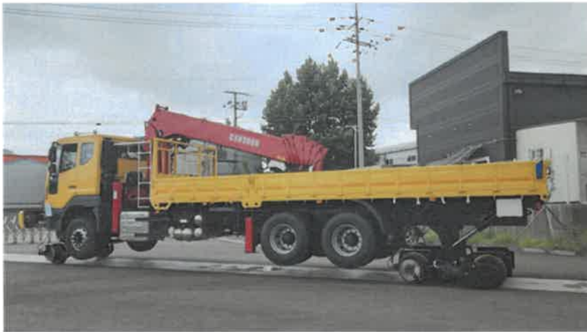
철도 및 도로 주행이 가능하도록 제작된 유지보수용 차량
